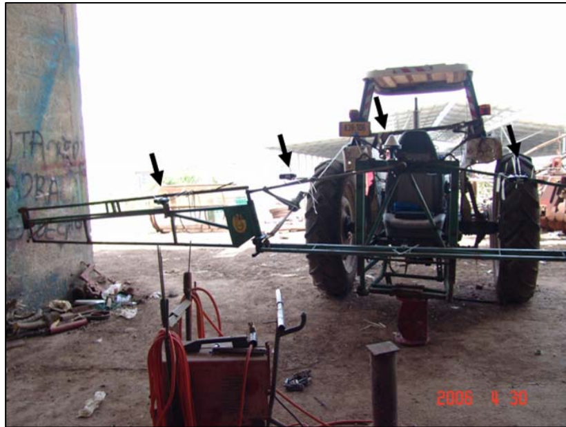
תמונה 2. זיווד המצלמות הדיגיטליות על הבוס. החיצים מתארים את מיקום המצלמות
