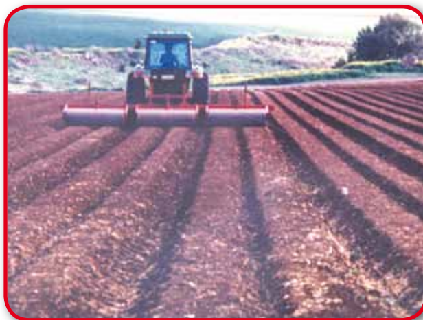
הערות: מתחחת "גלית" - ציר התיחוח ופחי ההנחתה מאחור, מותאמים לפרופיל הגודודיות.
